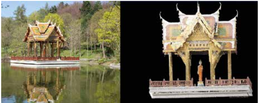
3D-Objekterfassung der Thailändische Sala mit TLS (ein Ergebnis der Hauptvermessungsübung)
