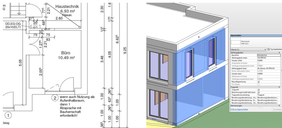
Abb. 2.3-1: Vergleich CAD-Zeichnung (links) und BIM-Modell (rechts).
