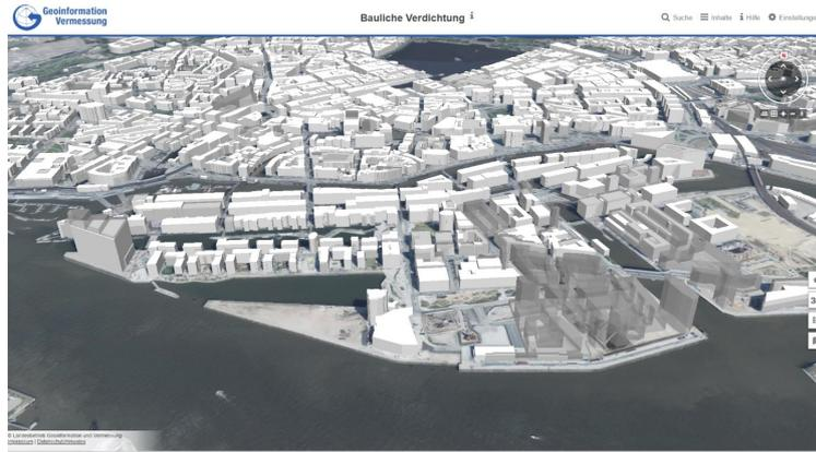
Abb. 2.7-8: Visualisierung von XPlanungs-konformen Geometrien überbaubarer Grundstücksflächen als CityGML Objekte.
