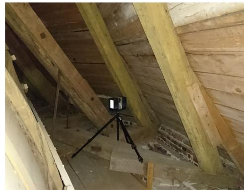
Abb. 3.1.6-2: Aufmaß des gesamten Bauwerks mit 3D-Laserscanning.
