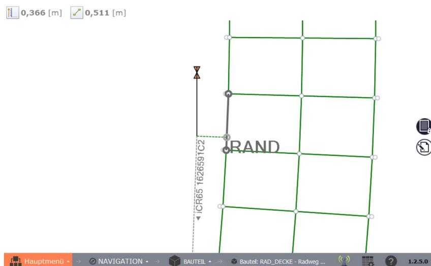
Abb. 3.1.12-3: Screenshot der Navigation, der die Anwendung nach der Selektion „Radweg Decke“ und „Linien“ zeigt. Dem Anwender wird dynamisch der aktuelle rechtwinklige Abstand (0,366 m) und die Höhendifferenz (0,511 m) zum Rand angezeigt.
