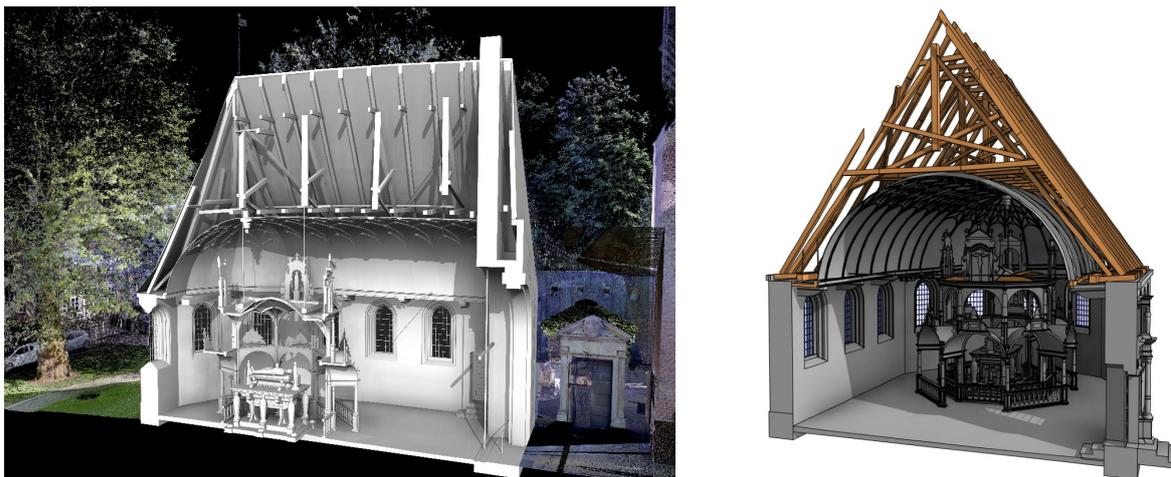
Abb. 3.1.6-4: Bauteilstrukturiertes Bestandsmodell (BIM) des Edo-Wiemken-Denkmal.
