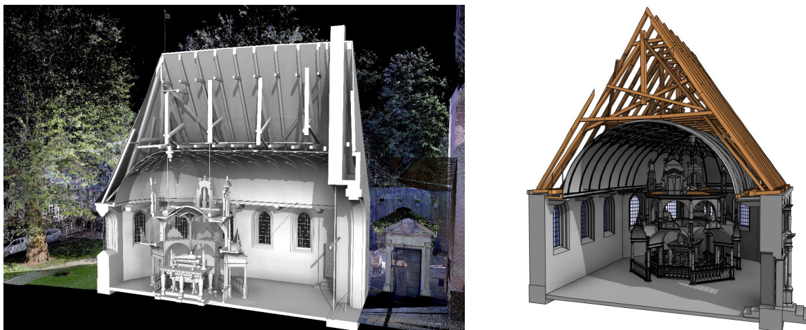
Abb. 3.1.6-4: Bauteilstrukturiertes Bestandsmodell (BIM) des Edo-Wiemken-Denkmal.
