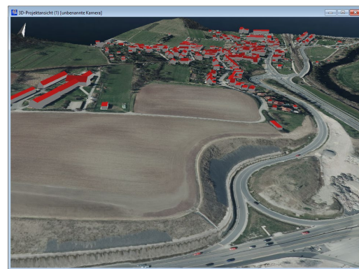
Abb. 3.2.7-9: Kombination aus DGM mit Luftbild auf der Oberfläche und 3D-Gebäuden in der 3D-Projektansicht.
