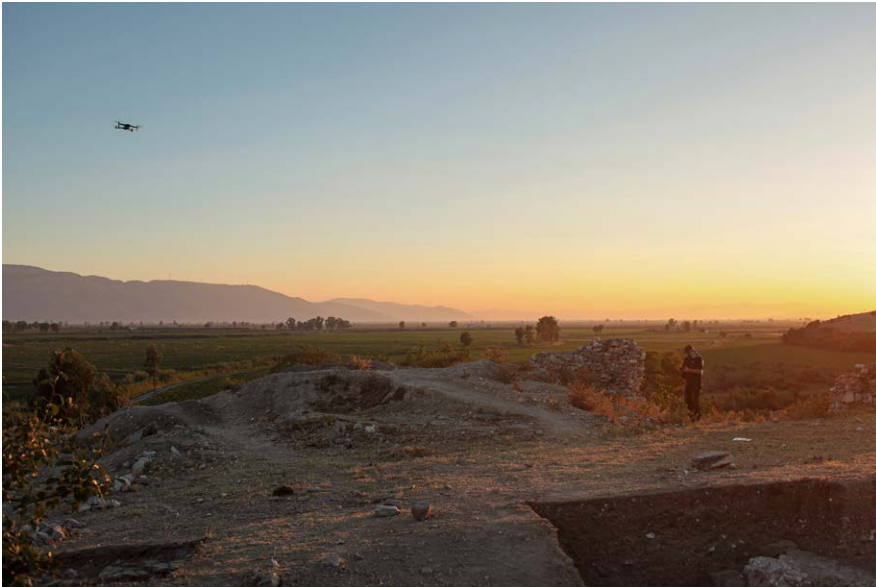
Links: Drohnenflug – UAV-Mapping in den Morgenstunden, um harte Schatten zu vermeiden. Rechts: Anzeichnen von Passpunkten in der Zisterne. Hierfür wurde ein Wachsstift an einem langen Ast als Armverlängerung festgebunden.
