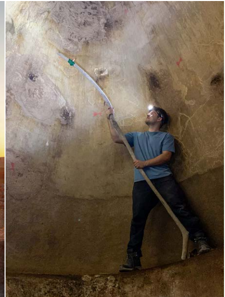
Links: Drohnenflug – UAV-Mapping in den Morgenstunden, um harte Schatten zu vermeiden. Rechts: Anzeichnen von Passpunkten in der Zisterne. Hierfür wurde ein Wachsstift an einem langen Ast als Armverlängerung festgebunden.
