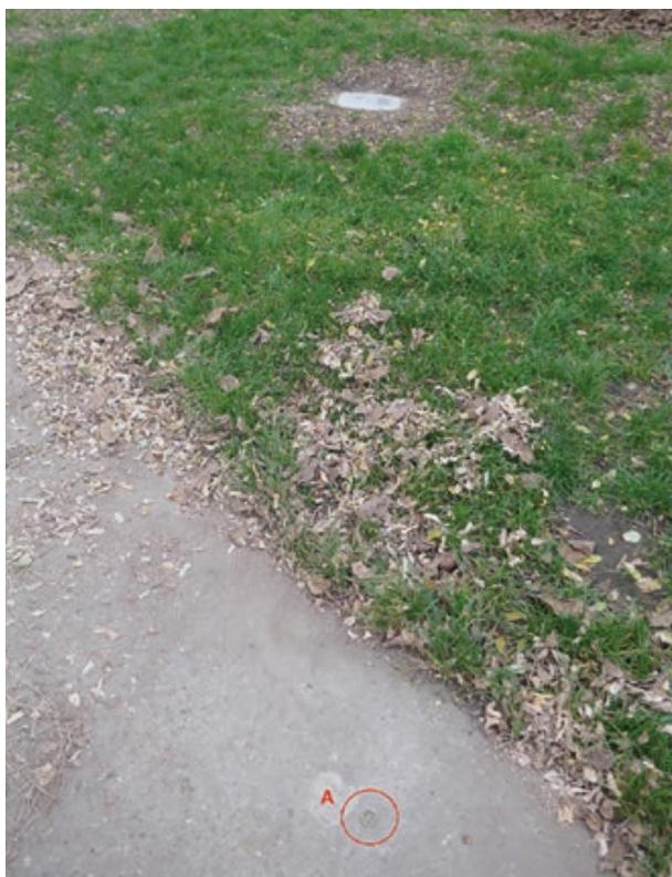
Abb. 17: Exzentrum A (Messingmarke auf dem betonierten Landwehrweg – roter Kreis) – im Hintergrund auf der Grünfläche das Zentrum Z (Betonplatte)
