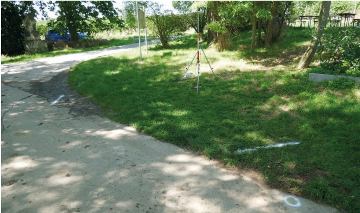
Abb. 10: Lage des Zentrums Wickert Warte 1810 / 1812 (Rotweißer Antennenstab mit Stabstativ) und des Exzentrums A (weißer Kringel rechts vorne auf dem Wegesrand) – Blick nach Westen
